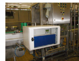
KEG-C工业在线电子鼻
